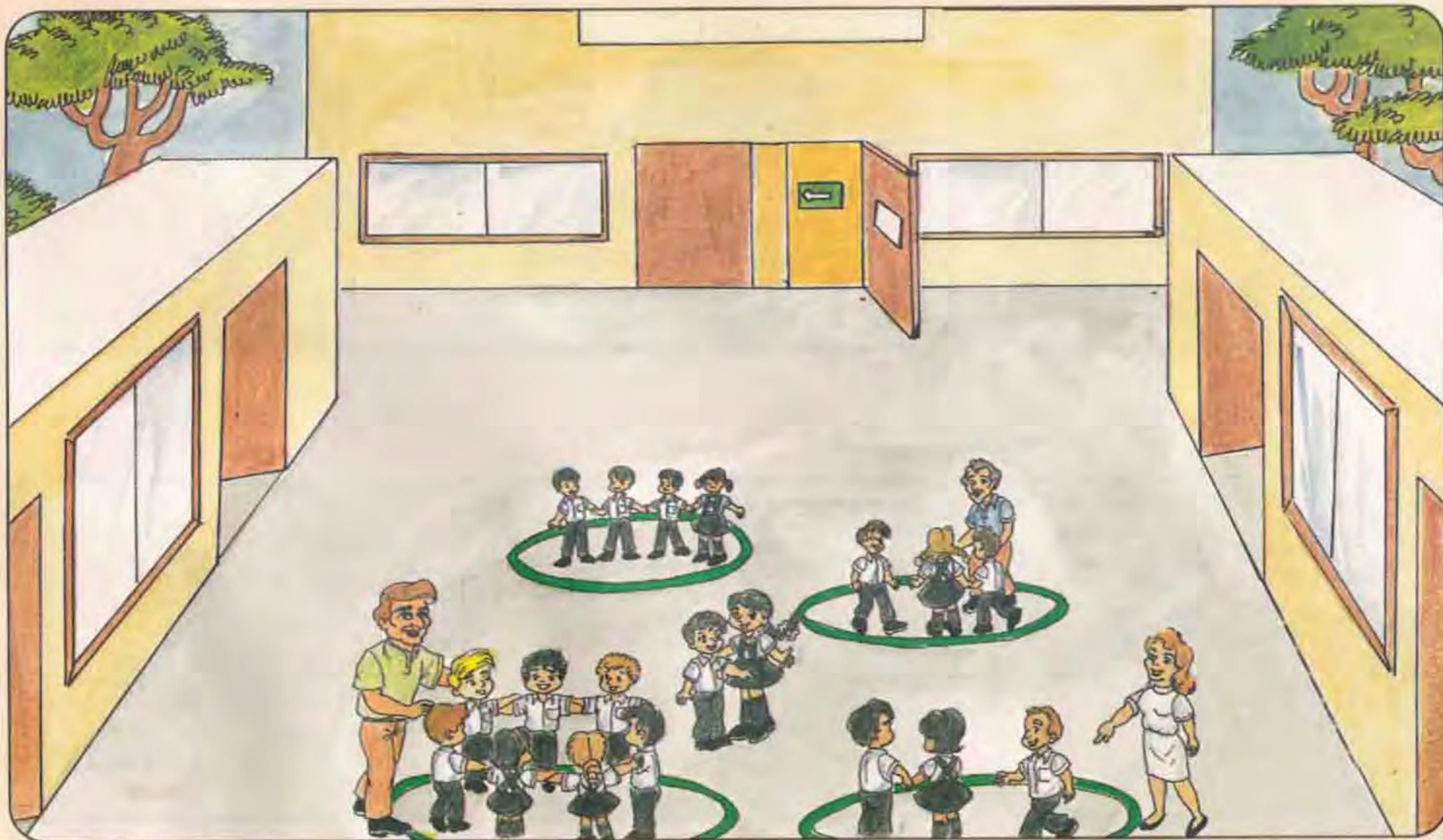
LOS CIRCULOS DE SEGURIDAD SE COLOCAN A UNA DISTANCIA EQUIVALENTE AL DOBLE DE LA ALTURA DE LA PARED MAS CERCANA.
