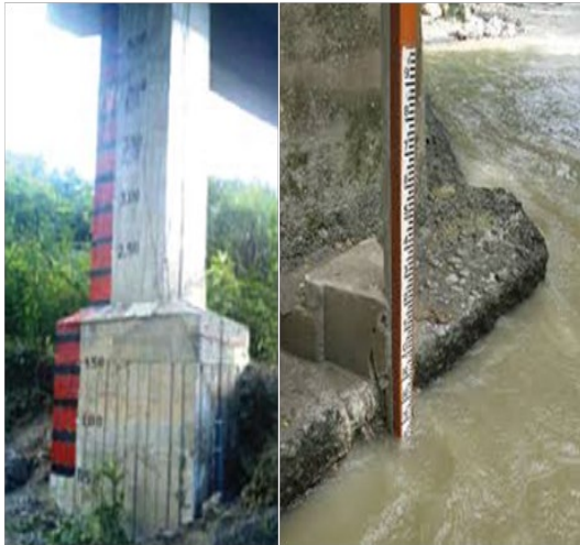
Figura 12: Escalas limnimétricas ubicadas en a) Puente y b) muro de concreto
