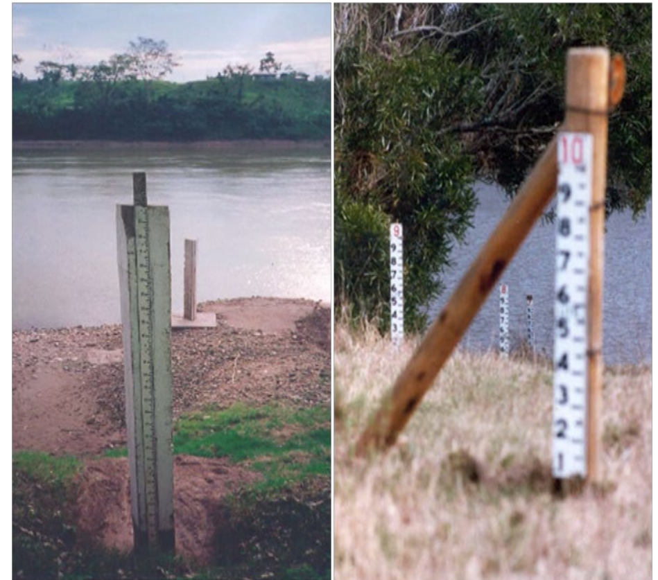
Figura 14: Limnómetros en serie instalados en el río Pachitea (Fuente: SENAMHI)
