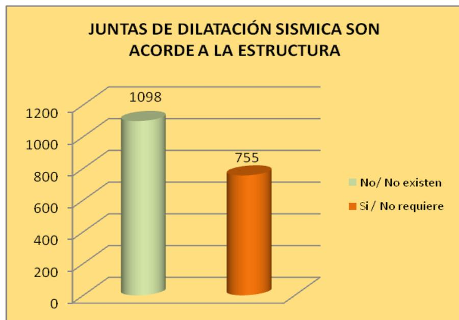
Las viviendas verificadas construidas con materiales precarios (adobe, quincha, madera, y otros) en un 59% no han considerado las juntas de dilatación sísmica. Muy probablemente se ha tomado este criterio que no es representativo para viviendas construidas con estos tipos de material.
