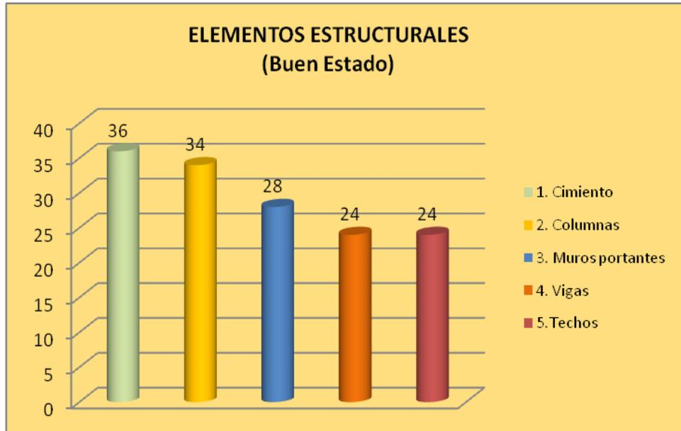
Del total de viviendas verificadas, reducido porcentaje presentan sus elementos estructurales en buen estado, indicando una vulnerabilidad baja ante la ocurrencia de un sismo.
