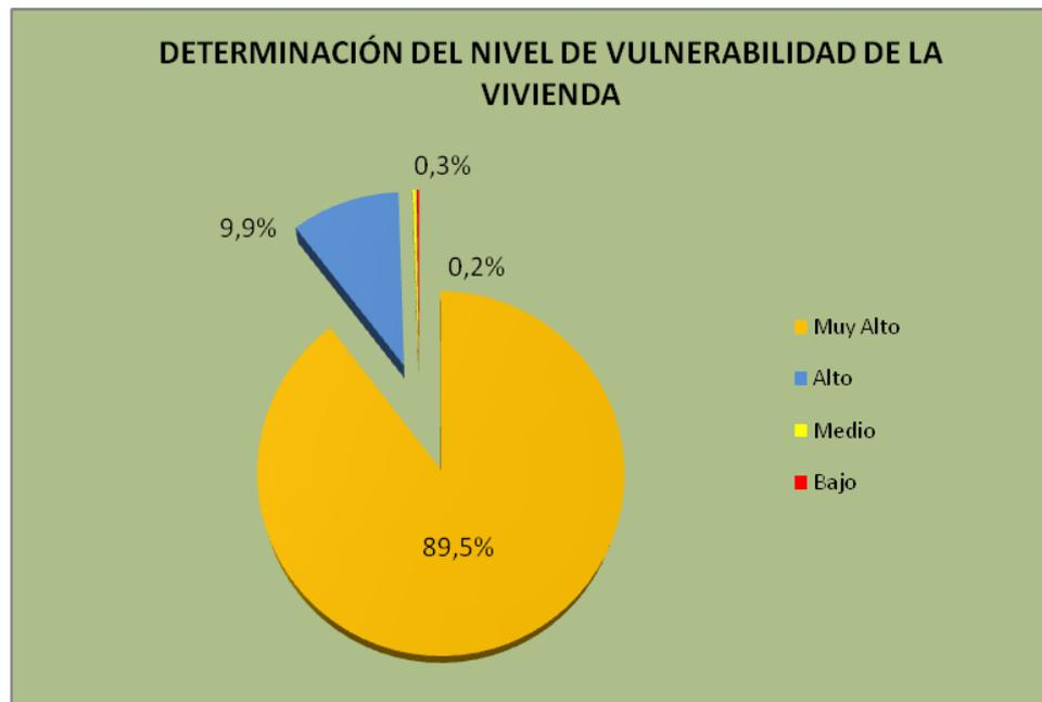
Haciendo un desagregado de las cantidades obtenidas, tenemos que en el 99.5% de las viviendas verificadas se halló una vulnerabilidad muy alta y alta. Indicando la gravedad de las construcciones en el distrito y su capacidad de respuesta ante un sismo.
