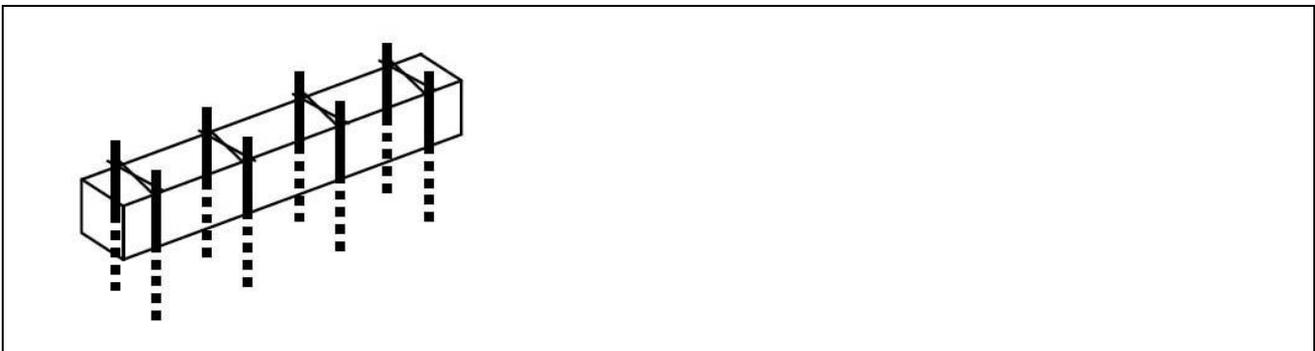
**Configuración (D): con doble viga de anclaje al suelo**
