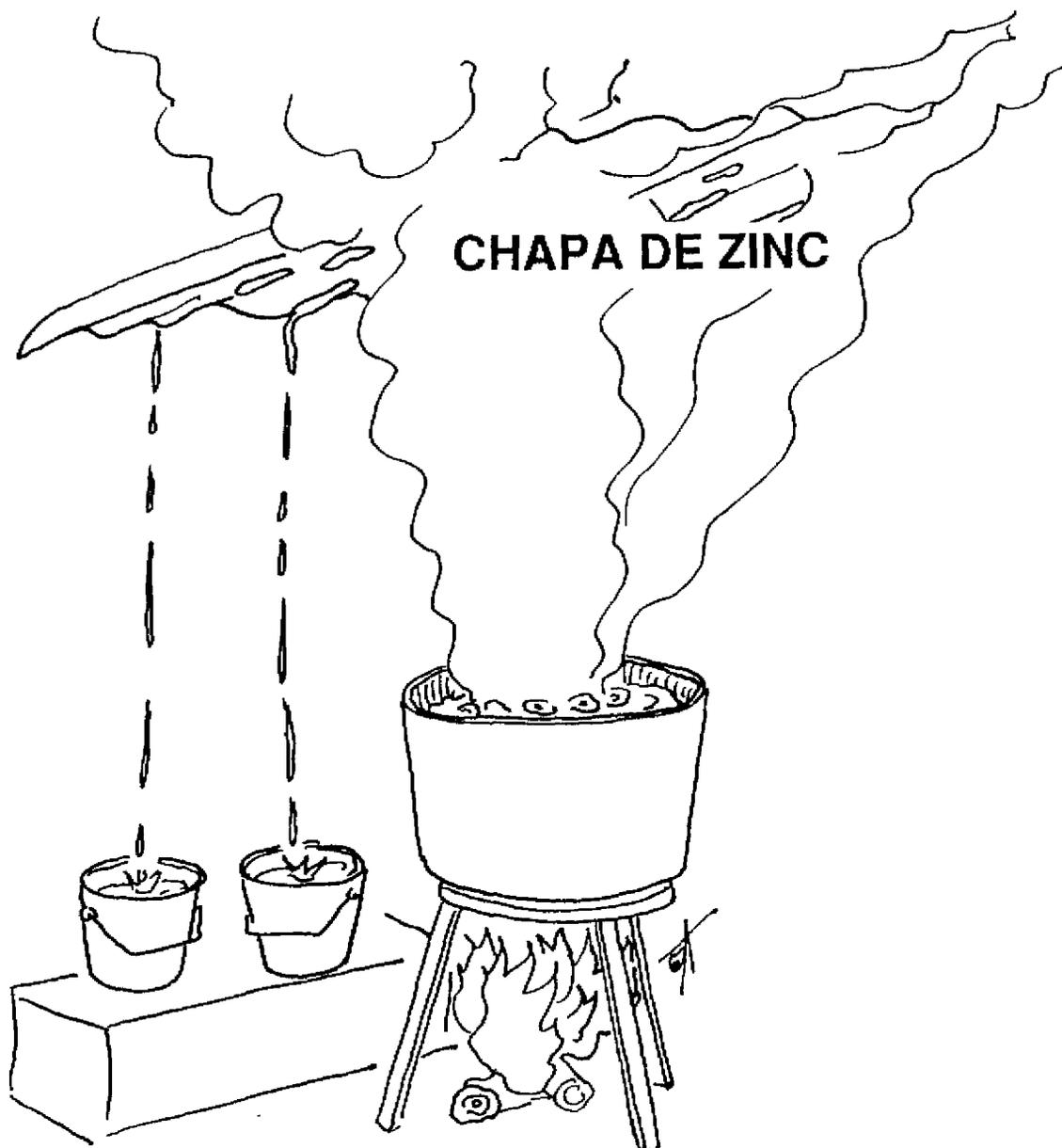
FIG. 32 ESQUEMA DE DESTILACION DE AGUA.
