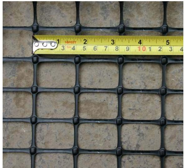
*Detalle geomalla de Polipropileno Tipo TENSAR*
