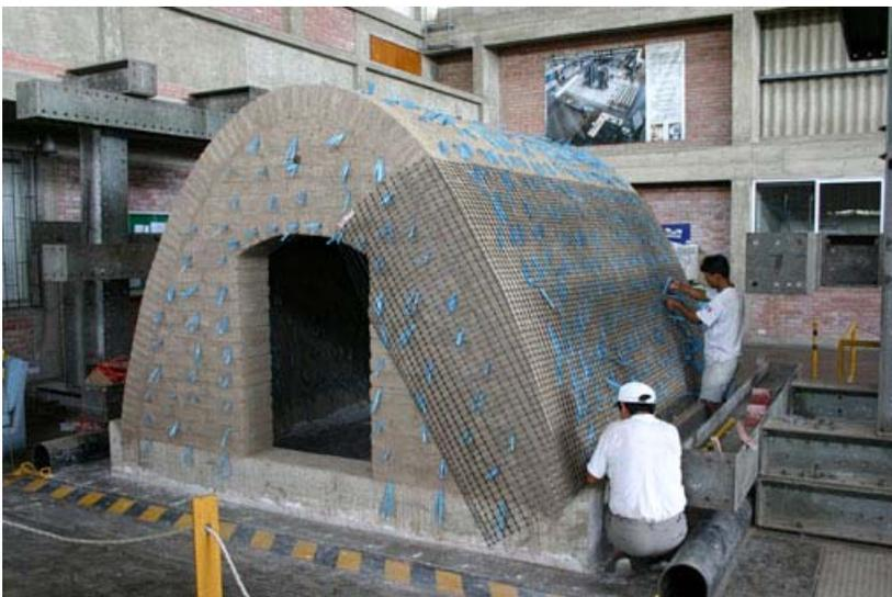
*Ejemplo aplicación de geomalla en construcciones de adobe sismorresistentes*
