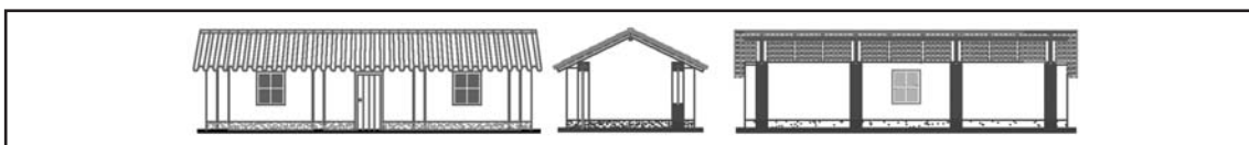
Módulo en adobe: elevación y cortes típicos
