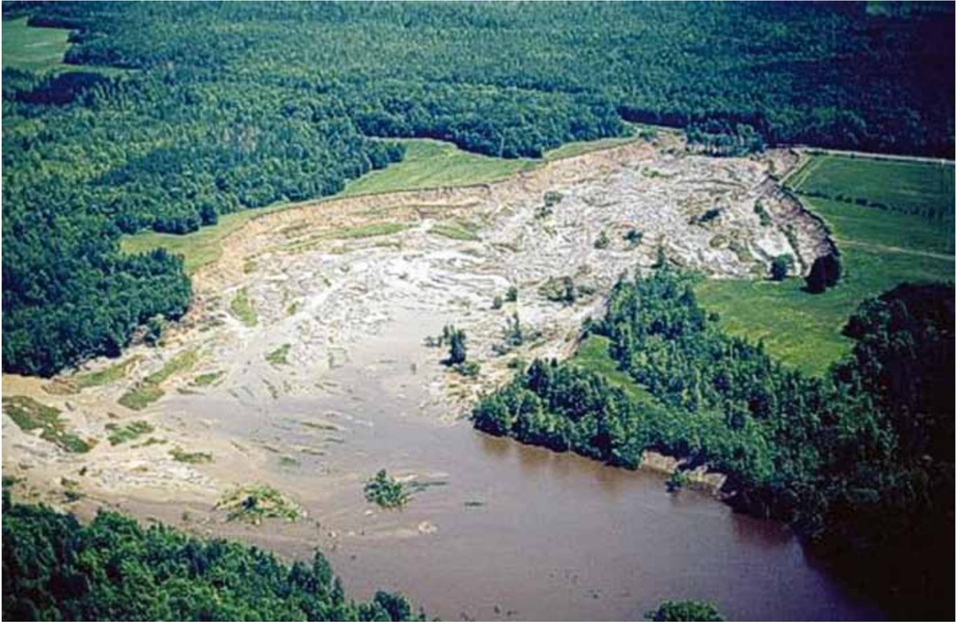
**Figura 20.** El 1993, el deslizamiento de tierra Lemieux, una corriente de tierra rápida en arcillas marinas vulnerables cerca de Ottawa, Canadá. El declive principal retrocedió 680 metros sobre el suelo plano por encima de la orilla del río. Unos 2,8 millones de toneladas de arcilla y limo se licuaron y confluyeron en el valle del Río South Nation, formando una presa en el río. (Fotografía de G.R. Brooks, Servicio Geológico del Canadá.)
