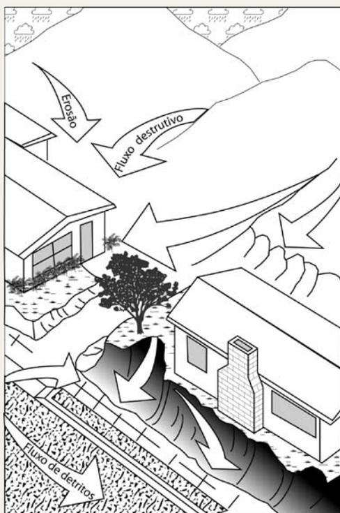
**Figura C38.** Esquema de una casa sin protección, en el trayecto de un flujo de escombros y (o) "alud de lodo". Los métodos sugeridos para reducir el riesgo de las corrientes de escombros se muestran en la figura C39.
