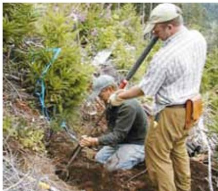
**Figura B8.** Medición del movimiento de los deslizamientos utilizando un extensómetro, un instrumento que puede detectar el movimiento de la superficie del suelo entre el suelo estable y el deslizamiento de tierra. (Fotografía de Richard LaHusen, Servicio Geológico de los Estados Unidos.)
