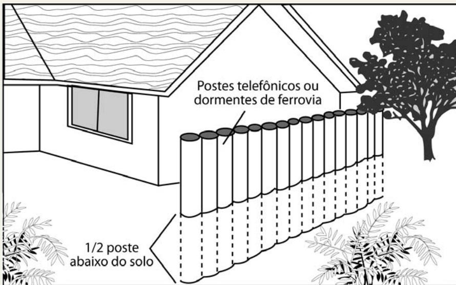
**Figura C51.** Una alternativa de los deflectores de la madera – secciones de poste de teléfono o durmientes de ferrocarril.
