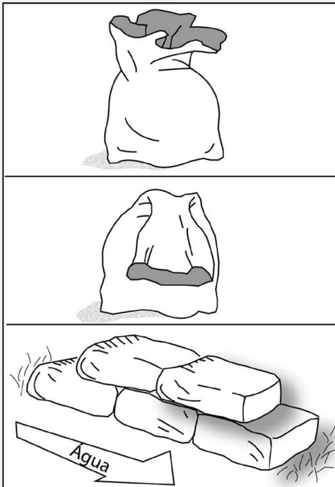
**Figura C41.** Los sacos de arena sirven básicamente para proteger contra corrientes bajas de hasta 0,6 metros (2 pies). Para proteger de corrientes más altas se necesita una estructura de tipo más permanente. Cabe señalar que los sacos de arena no impermeabilizan para impedir la entrada del agua.
