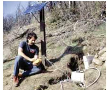
**Figura B9.** Prueba de un sistema de radioteleetría accionado por energía solar para la transmisión a distancia de datos sobre deslizamientos de tierra en tiempo real. (Fotografía de Mark Reid, Servicio Geológico de los Estados Unidos).
