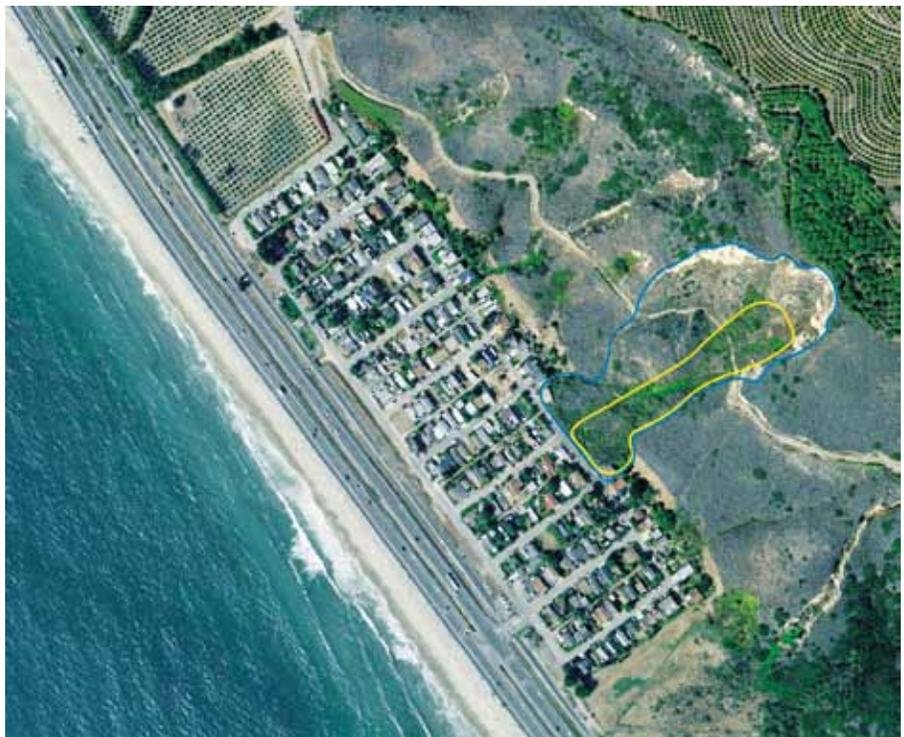
**Figura B4.** Ejemplo de una fotografía aérea del deslizamiento de La Conchita, en California, EE.UU., realizada en 2005. La línea azul delinea un deslizamiento de tierra de más edad, la línea amarilla un deslizamiento de tierra más reciente. (Fotografía por cortesía de AirPhoto USA y el Condado de Ventura, California, y Randy Jibson, Servicio Geológico de los Estados Unidos).
