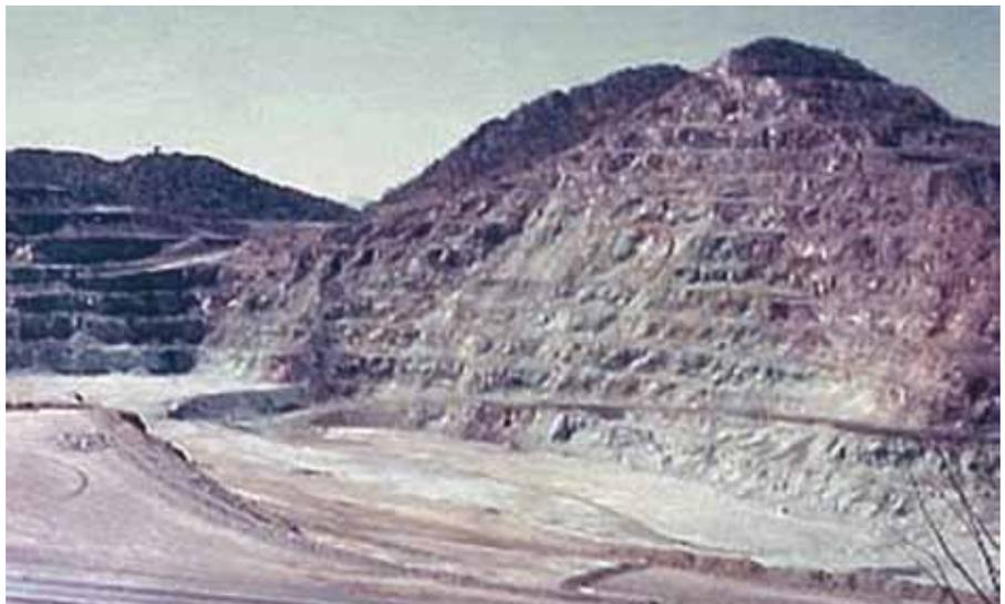
**Figura C28.** Esquema y fotografía de bancos de roca. (Esquema tomado de la Referencia 11, fotografía de una mina en Tucson, Arizona, Estados Unidos, por Steve Dutch, Universidad de Wisconsin, Estados Unidos).
