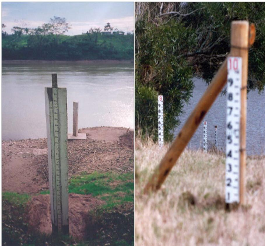
Figura 14: Limnómetros en serie instalados en el río Pachitea (Fuente: SENAMHI)
