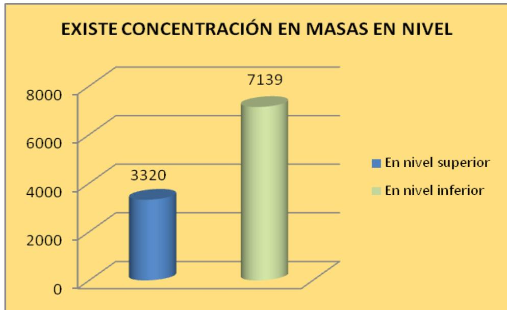
Las altas concentraciones de masas en algún nivel de la vivienda se deben a la disposición de elementos pesados, tales como equipos, tanques, bodegas, archivos, etc. El problema es mayor en la medida en que dicho nivel pesado se ubica a mayor altura, debido a que las aceleraciones sísmicas de respuesta aumentan también hacia arriba, con lo cual se tiene una mayor fuerza sísmica de respuesta allí y por ende una mayor posibilidad de volcamiento.
