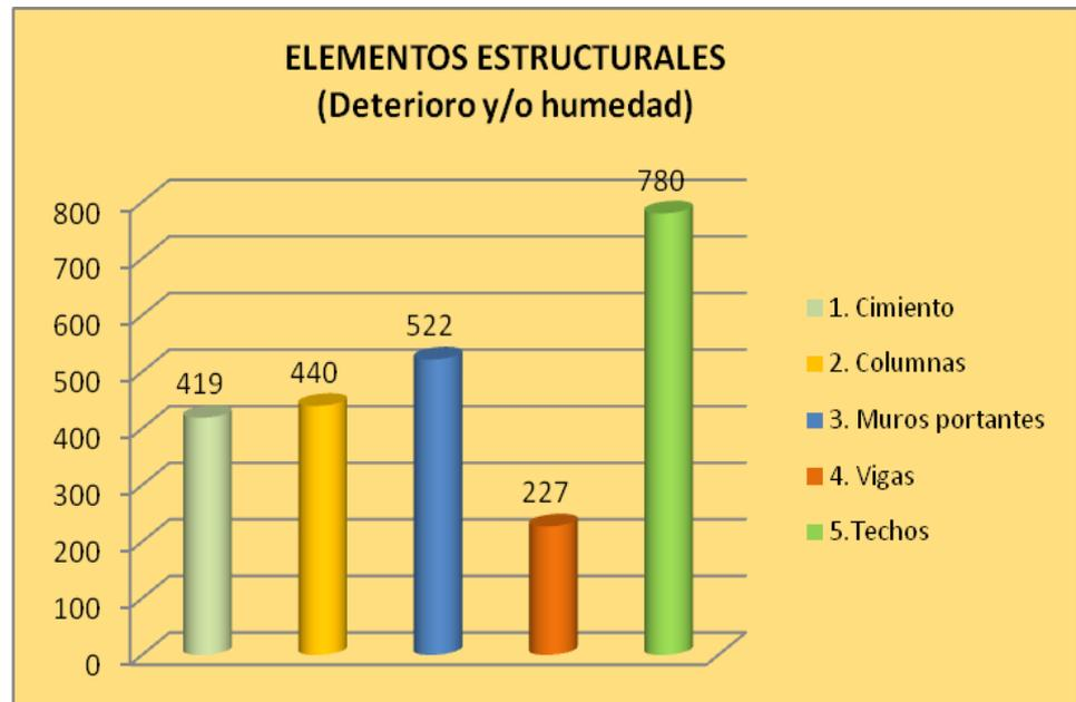
Del total de viviendas verificadas, la mayor incidencia de casos se centra en el deterioro y/o humedad de los techos, con un 33% (780), vulnerabilidad que se incrementaría en el caso de las viviendas que además tienen la cimentación y las columnas en el mismo estado de afectación, haciéndolas menos resistentes ante la presencia de un sismo.
