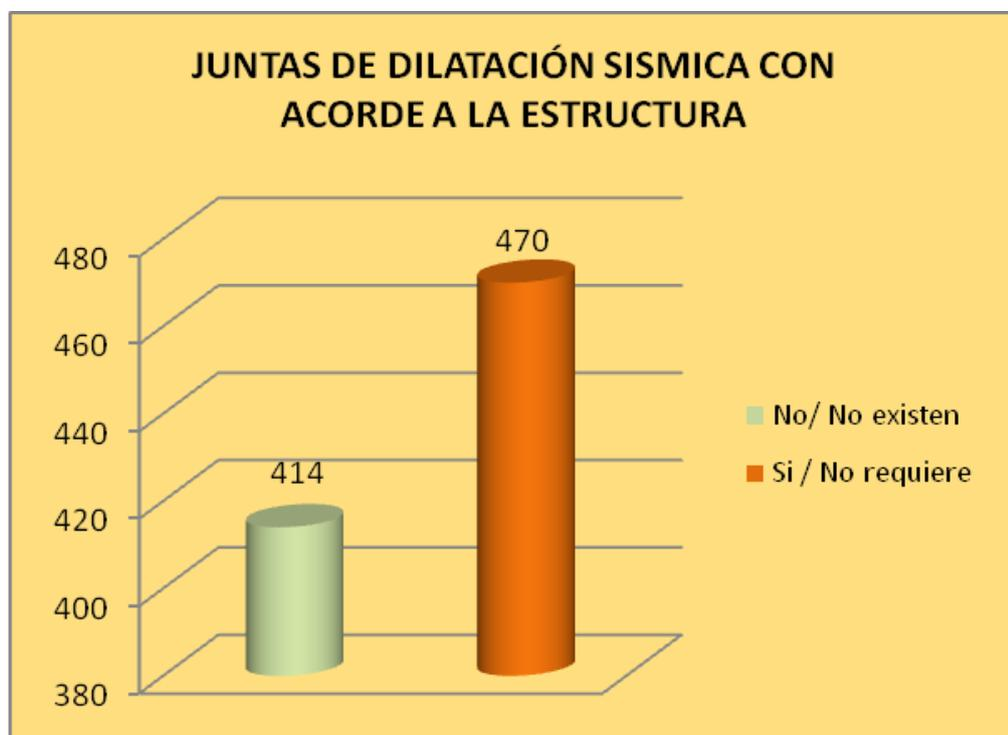
Las viviendas verificadas construidas con materiales precarios (adobe, quincha, madera, y otros) en un 47% no han considerado las juntas de dilatación sísmica. Muy probablemente se ha tomado este criterio que no es representativo para viviendas construidas con estos tipos de material.
