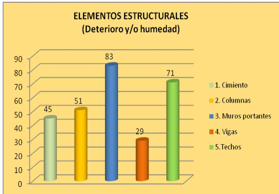
Del total de viviendas verificadas, la mayor incidencia de casos se centra en el deterioro y/o humedad de los cimientos muros y columnas, con un 64% (179), haciéndolos menos resistentes ante la presencia de un sismo.
