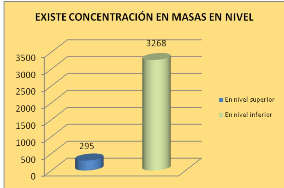
Las altas concentraciones de masas en algún nivel de la vivienda se deben a la disposición de elementos pesados, tales como equipos, tanques, bodegas, archivos, etc. El problema es mayor en la medida en que dicho nivel pesado se ubica a mayor altura, debido a que las aceleraciones sísmicas de respuesta aumentan también hacia arriba, con lo cual se tiene una mayor fuerza sísmica de respuesta allí y por ende una mayor posibilidad de volcamiento.
