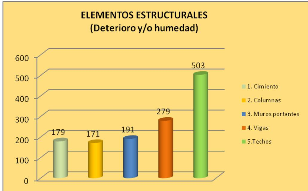
Del total de viviendas verificadas, la mayor incidencia de casos se centra en el deterioro y/o humedad de los cimientos, con un 14% (179), vulnerabilidad que se incrementaría en el caso de las viviendas que además tienen la muros y las columnas en el mismo estado de afectación, haciéndolas menos resistentes ante la presencia de un sismo.
