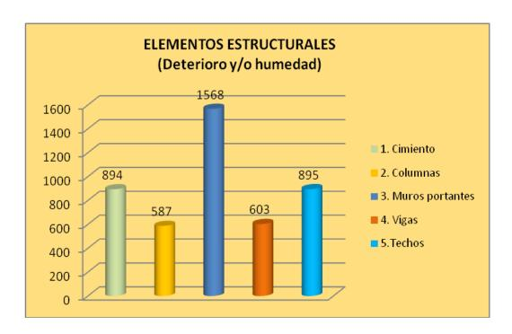
Del total de viviendas verificadas, la mayor incidencia de casos se centra en el deterioro y/o humedad de los muros portantes, vulnerabilidad que se incrementaría en el caso de las viviendas que además tienen la cimentación y las columnas en el mismo estado de afectación, haciéndolas menos resistentes ante la presencia de un sismo.
