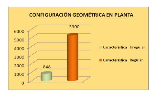
Para el 86% de viviendas verificadas, la configuración geométrica presente en este tipo de construcciones es **Regular**. Obteniendo con ello estructuras más estables ante un sismo.
