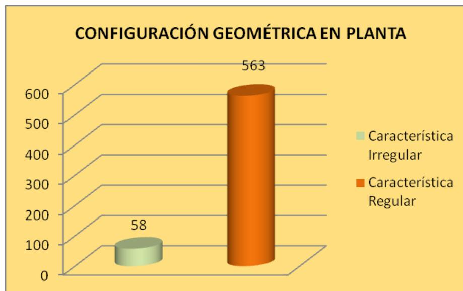
Para el 91% de viviendas verificadas, la configuración geométrica presente en este tipo de construcciones es **Regular**. Obteniendo con ello estructuras más estables ante un sismo.
