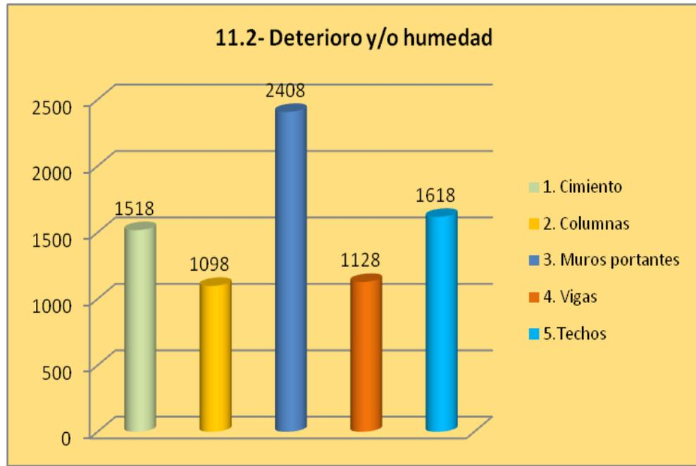
Del total de viviendas verificadas, la mayor incidencia de casos se centra en el deterioro y/o humedad de los muros portantes, vulnerabilidad que se incrementaría en el caso de las viviendas que además tienen la cimentación y las columnas en el mismo estado de afectación, haciéndolas menos resistentes ante la presencia de un sismo.
