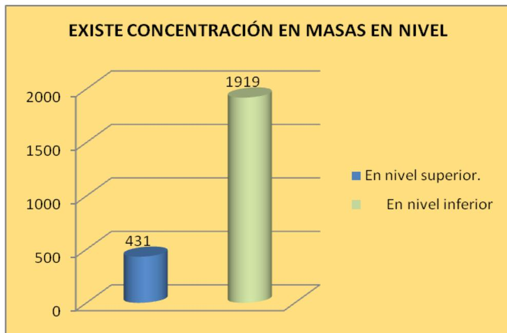
Las altas concentraciones de masas en algún nivel de la vivienda se deben a la disposición de elementos pesados, tales como equipos, tanques, bodegas, archivos, etc. El problema es mayor en la medida en que dicho nivel pesado se ubica a mayor altura, debido a que las aceleraciones sísmicas de respuesta aumentan también hacia
