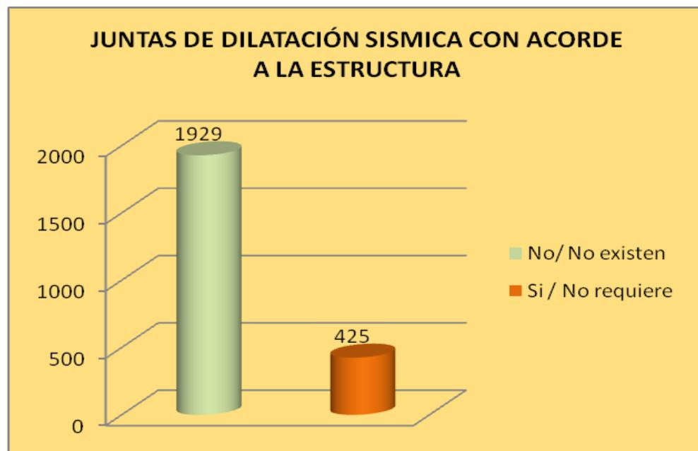
Las viviendas verificadas construidas con materiales precarios (adobe, quincha, madera, y otros) en un 82% no han considerado las juntas de dilatación sísmica. Muy probablemente se ha tomado este criterio que no es representativo para viviendas construidas con estos tipos de material.
