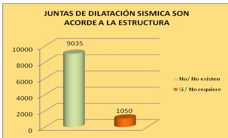
Las viviendas verificadas construidas con materiales precarios (adobe, quincha, madera, y otros) en un 90% no han considerado las juntas de dilatación sísmica. Muy probablemente se ha tomado este criterio que no es representativo para viviendas construidas con estos tipos de material.
