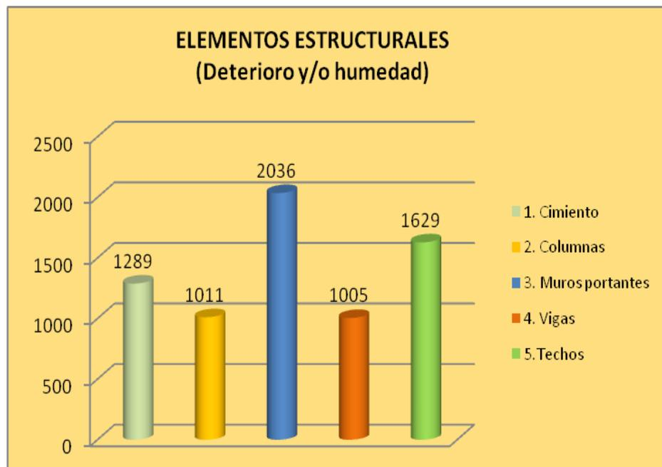
Del total de viviendas verificadas, la mayor incidencia de casos se centra en el deterioro y/o humedad de los muros portantes, con un 29% (2,036), vulnerabilidad que se incrementaría en el caso de las viviendas que además tienen la cimentación y las columnas en el mismo estado de afectación, haciéndolas menos resistentes ante la presencia de un sismo.
