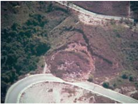
Figura 1.15 (a) Deslizamiento rotacional, Caracas, Venezuela (Fotografía D. Salcedo) (b) Deslizamiento rotacional de Yauriquilla, margen izquierda del río del mismo nombre; en rocas intrusivas muy alteradas, Carretera Curasco – Progreso, Apurímac, Perú (Fotografía B. Zavala).
