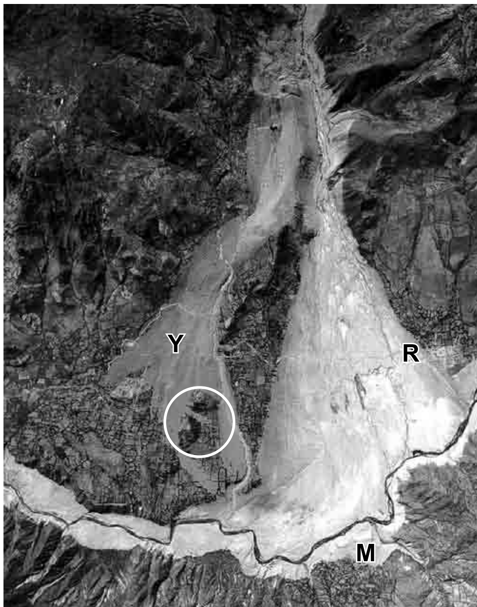
Figura B.4.5 Fotografía aérea de los depósitos del flujo de detritos de 1970 el cuál se inició como un desprendimiento de hielo y roca sobre la cara oeste del pico norte del Huascarán. Y: Frente de Yungay; R: Ranrahirca; M: Matacoto. La colina del Cementerio es mostrada con un círculo. Nótese la traza significativa aguas abajo del flujo/inundación de detritos abajo del río Santa a la izquierda (Fotografía Fuerza Aérea de los Estados Unidos).
