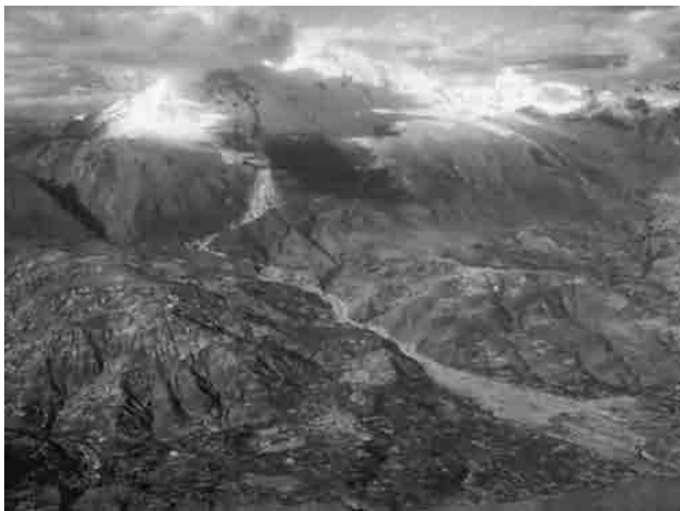
Figura B.4.3 Vista oblicua del recorrido de la caída de rocas y flujo de detritos en el río Shacsa de 1962. Nótese el origen en la cara occidental del pico norte del Huascarán y su extensión sobre el abanico de Ranrahirca (Fotografías Servicio Aerofotográfico Nacional de Perú).
