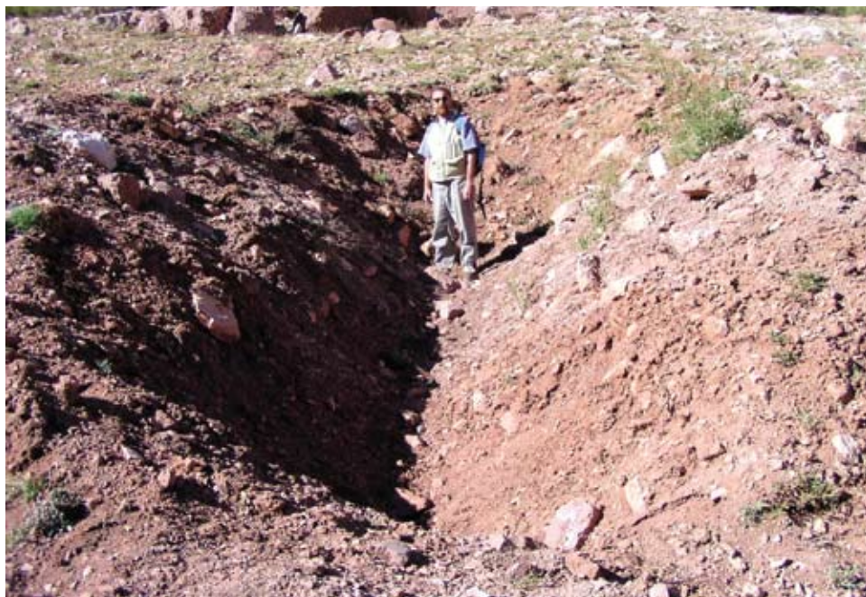
Figura A.3.3 Hoyo producido por el impacto del bloque en su recorrido ladera abajo. Su profundidad es de aproximadamente 2 m.
