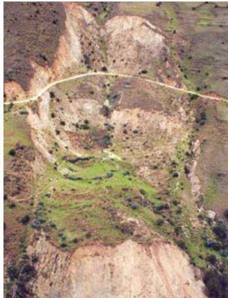
Figura 1.14 Deslizamiento rotacional ocurrido en la Provincia de Chimborazo, Paccha, Ecuador, 2004 (Fotografía Kashypa Yada).
