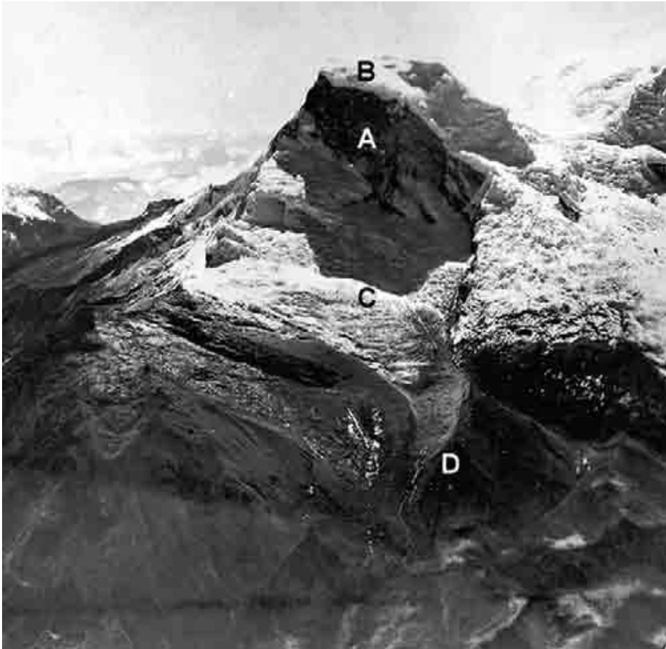
Figura B.4.2 Aerofotografía oblicua del pico norte del Huascarán antes del evento de 1962. Tanto los movimientos de masa de 1962 como el de 1970 se originaron como desprendimientos del flanco empinado occidental (A). El basamento rocoso consiste en granodiorita masivamente diaclasada. Nótese la cima de la capa glaciar (B). En ambos eventos la masa fragmentada viajó sobre la superficie inclinada del Glaciar 511 (C) y fue canalizada por el sistema de morrenas terminales de la pequeña Edad de Hielo (D). Asumimos que la pared occidental es el escarpe de la avalancha de rocas Precolombina, de la que sus materiales cubrieron las vertientes bajo el Huascarán y rellenaron el valle del río Santa (Fotografías Servicio Aerofotográfico Nacional de Perú).
