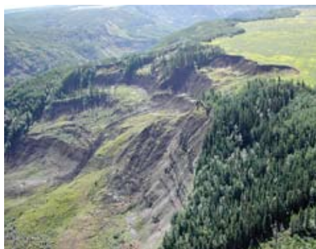
Figura 5.13 Deslizamiento compuesto (Peace River, BC, Canadá).
