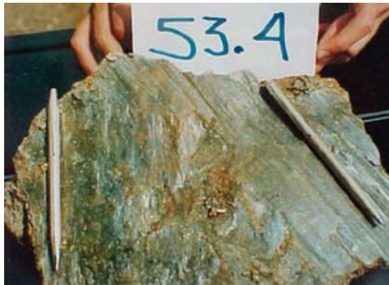
Figura A.4.5 Dos generaciones de estrías y superficies pulidas (slickensides), en muestra obtenida en la galería exploratoria.
