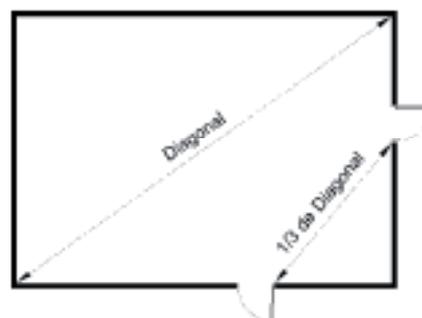
1. En caso la edificación no cuente con un sistema de rociadores, las escaleras deberán ubicarse en rutas opuestas con una distancia mínima entre puertas de escape equivalente a  $1/2$  de la diagonal mayor de la planta del edificio al que sirven.
