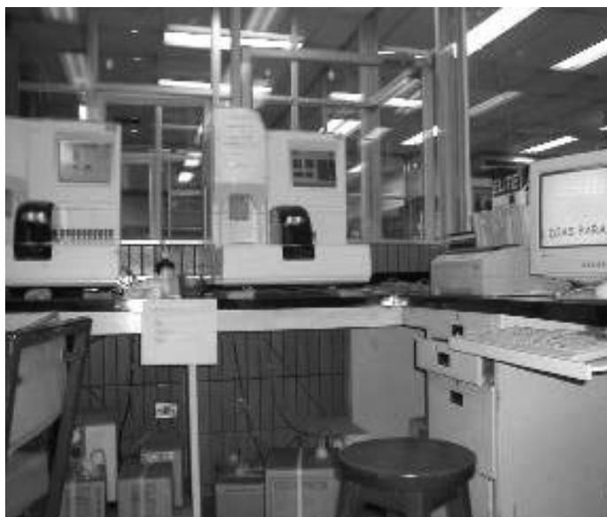
Figura 10. Falta de fijación de equipos en laboratorio.
