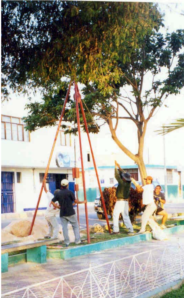
Foto N° 16. Ensayo de SPT en la plaza de armas de Pocollay
