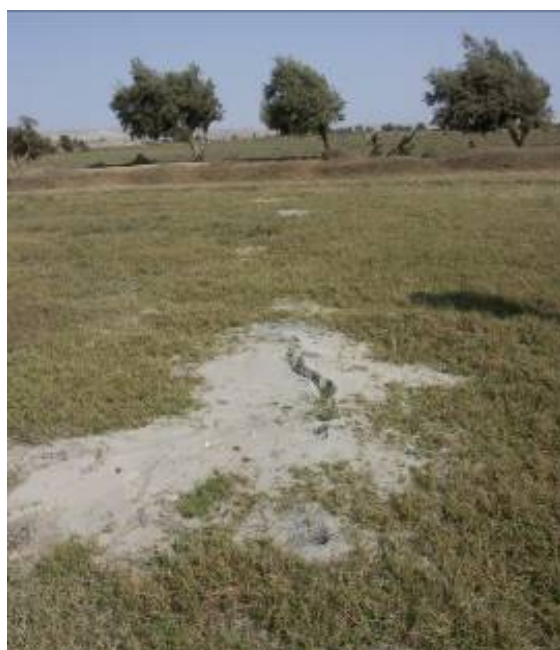
Foto 4.20: Procesos de licuación de suelos con generación de fuertes agrietamientos en los límites de parcelas de chacras, en el sector entre Camacho y San Martín.
