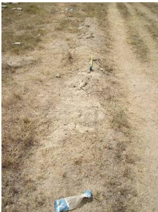
Foto 4.6: Por efecto de la compresión, el terreno sufrió un fenómeno de abovedamiento superficial.
