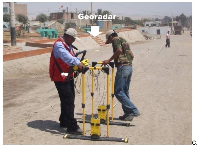
Figura 5.6: Equipos utilizados en la instrumentación geofísica. a). Sismógrafo de banda ancha. b). sismógrafo de refracción y c). Equipo de Georadar.
