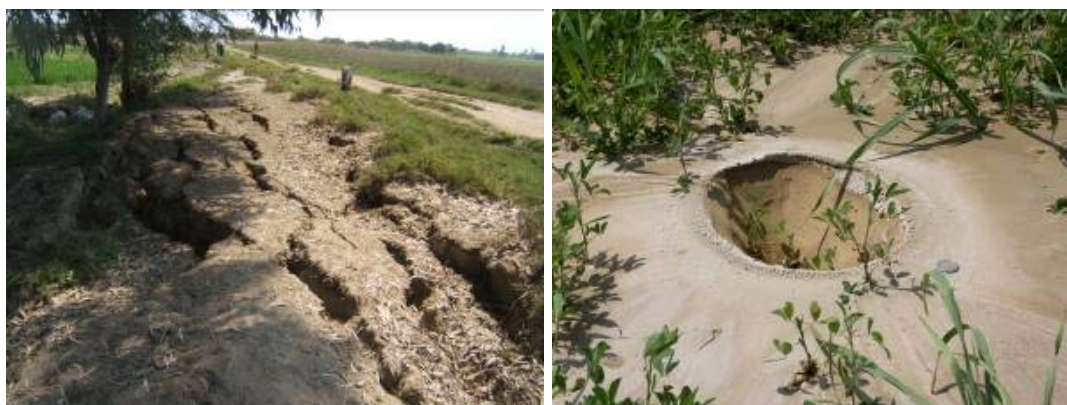
Foto 4.29: Toscanía, Montalbán y Manrique, se resaltan las zonas afectadas por licuación de suelos, donde incluye amplias zonas de cultivos, trochas carrozables y drenes de agua.
