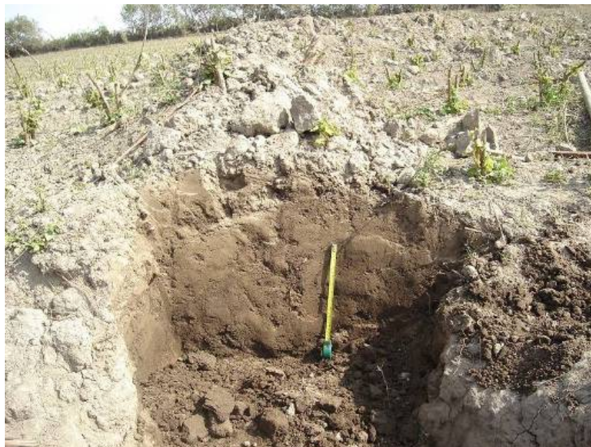
Foto 4.15: Calicata que no revelo mayores detalles del origen de la deformación.
