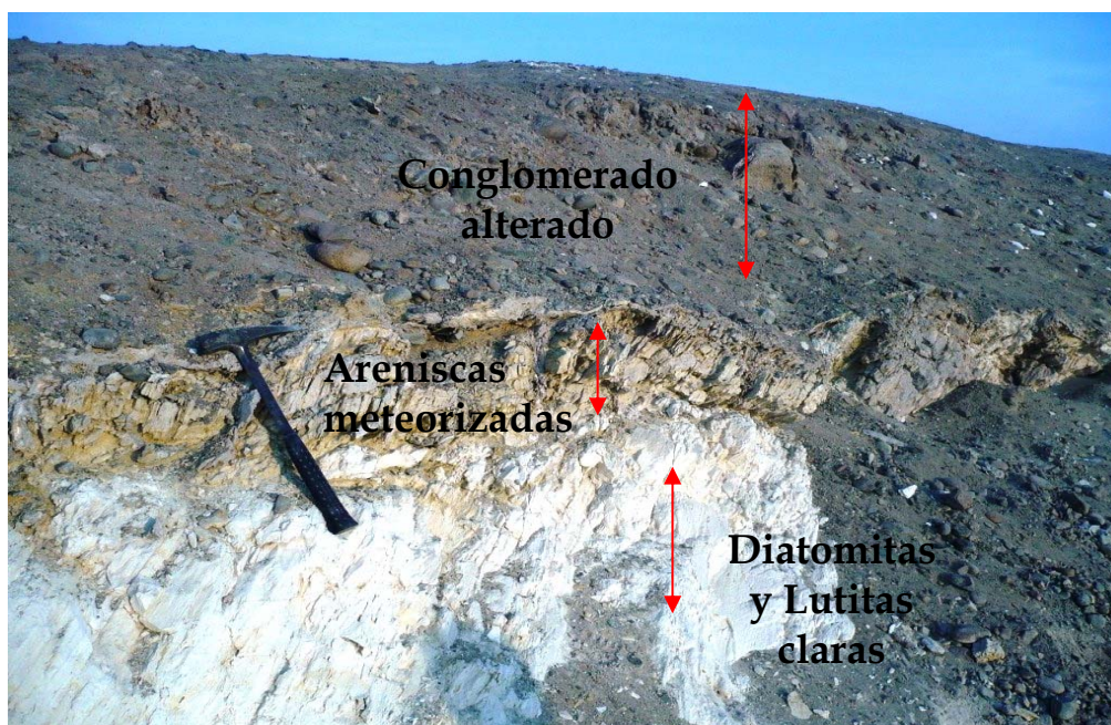
Foto N° 5.12: Secuencia que muestra al conglomerado alterado con matriz arenosa, cubriendo a las arenas poco compactas.
