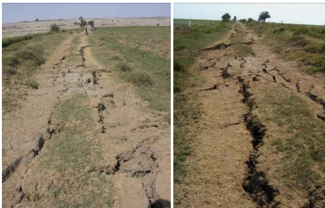
Foto 4.20: Procesos de licuación de suelos con generación de fuertes agrietamientos en los límites de parcelas de chacras, en el sector entre Camacho y San Martín.
