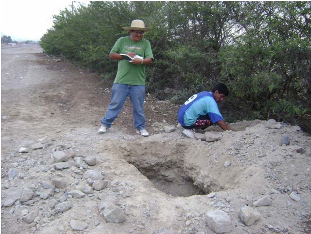
FOTO N° 02: Calicata N°04, ubicado al lado derecho de la carretera Chíncha Alta-Alto Larán, a la altura de la UPIS Santa Ana de Alto Larán, nótese el material de arena mal graduada con limo y grava.
