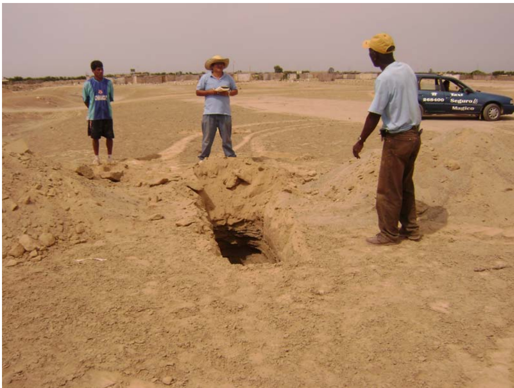
FOTO N° 09: Calicata N° CP1, ubicado en el área de expansión de Pueblo Nuevo, corresponde a un suelo areno arcillo limoso, sin piedras.
