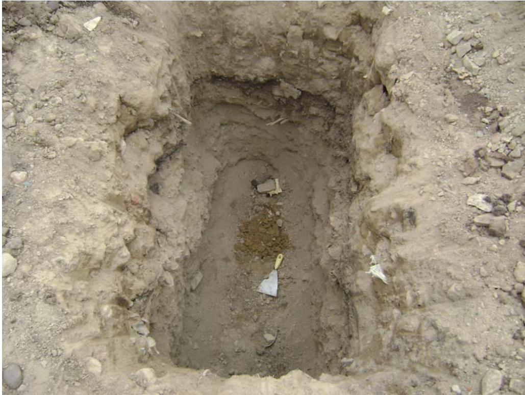
FOTO N° 01: Calicata N° 01, ubicado al lado izquierdo de la carretera Chíncha Alta-Alto Larán. Como cobertura se nota la presencia de desmonte y basura, el material del fondo corresponde a un suelo limo arenoso.
