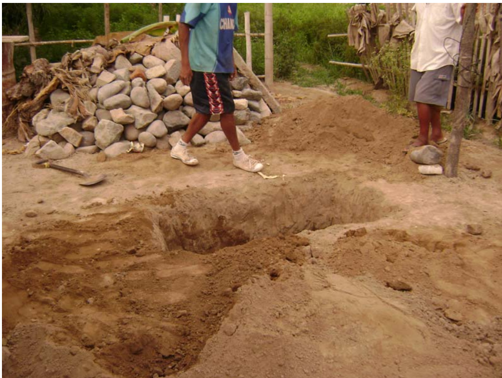
FOTO N° 07: Calicata N°16, ubicado en el Bosque de Sunampe, el suelo corresponde a un material areno limoso, sin piedras.
